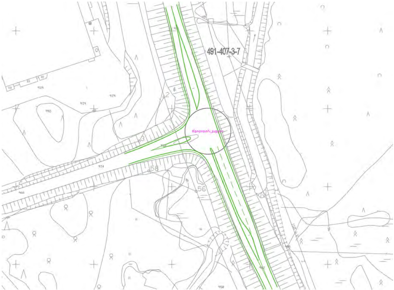
Kuva 25: Suppean kanavoinnin kaistajärjestely, jossa toteutettaisiin vain liittymän etelähaarakalle kääntymiskaista
